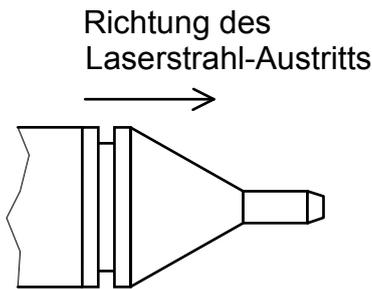
Die Spitze des Silberbauer - *CL-plus*-Lasers ist aus rostfreiem Stahl in Form eines Röhrchens gestaltet, das aus einem Konus herausragt. Dadurch ist es möglich, in jedem Falle gut an die Stelle zu sehen, wo die Laserstrahlung auf die Haut auftrifft. Selbst schlecht zugängliche Punkte der Ohrakupunktur lassen sich so mühelos bestrahlen.
